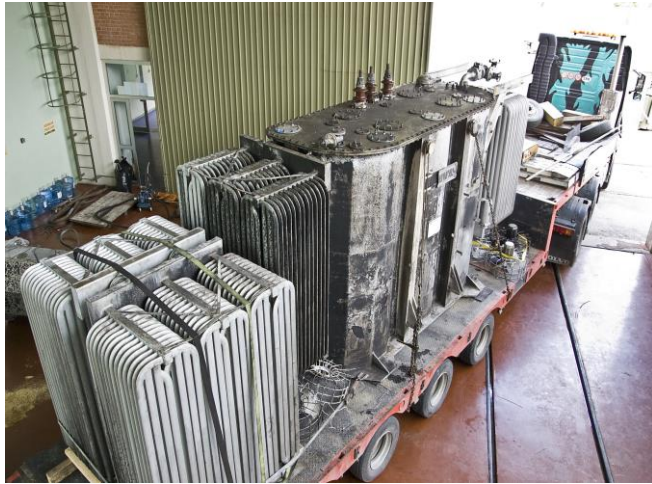
Slika 1: Prikaz havariisanog energetskog transformatora kao posledice eksplozije PI
